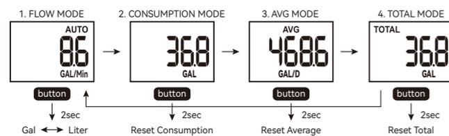
**Drücken Sie kurz die Taste:** Das Display wechselt in den nächsten Anzeigemodus.
