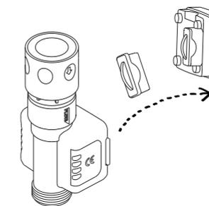
2. Nehmen Sie die Batterieabdeckung heraus, legen Sie eine CR2032-Batterie ( im Lieferumfang enthalten) gemäß den Anweisungen neben dem Batterieschacht ein, und setzen Sie die Batterieabdeckung wieder fest ein.
